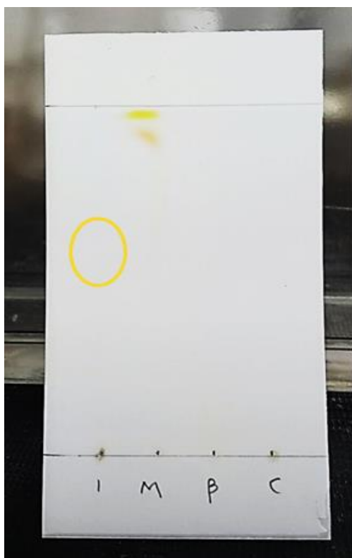
Anexo 4. Cromatografía en capa fina para la detección de carotenoides de dos muestras de semillas de amaranto. Los carotenoides se observan como manchas de color naranja o amarillo. Además de las dos manchas prominentes que corrieron a partir del estándar de mandarina, existe una mancha de color naranja apenas perceptible que surge de la muestra de semillas de la finca ligada a IMAP. I: muestra de IMAP, M: estándar de mandarina, \beta : estándar de \beta -caroteno ya caducado, C: muestra de asociación CDRO.
