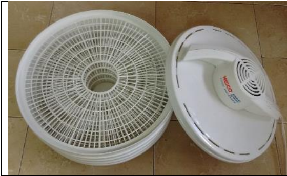
Imagen 3 – deshidratadora utilizada para los ejemplares previo a su empaque. Los ejemplares son desecados en función de la humedad remanente, previo a poder empaquetarse de forma aislada.
