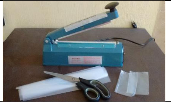
Imagen 4 – selladora de calor para los empaques donde se aíslan los especímenes. Tras su curación y desecado, los ejemplares deben re-empaquetarse con sumo cuidado.
