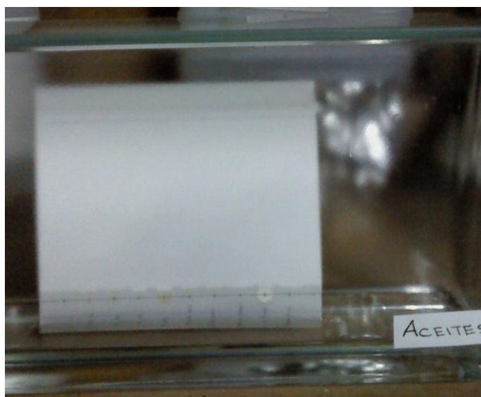
Imagen No. 2 Cromatoplaaca en cámara con fase móvil
