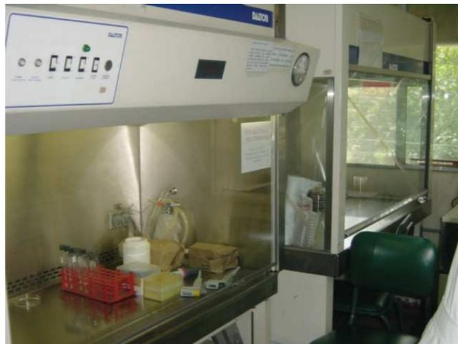
Fig. 4 Campana en donde se preparan los medios y se inoculan los sustratos
