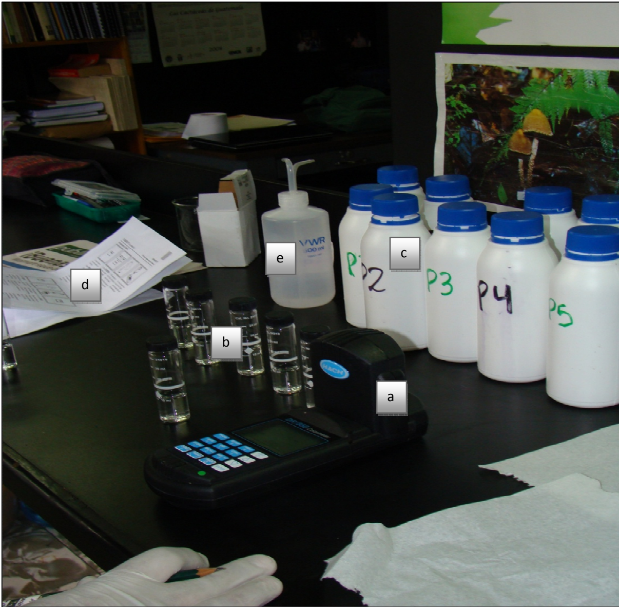
Fotografía 1. Equipo para medir las concentraciones de amonio, nitrato y fosfato.
