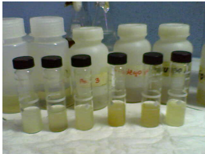
Sulfatos (turbiedad indica presencia de sulfatos)
